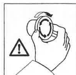
Principio de funcionamiento del pulsador de emergencia
